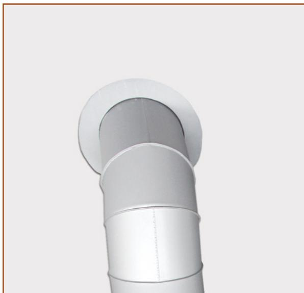
Les chauffe-eau au gaz nécessitent une bonne ventilation. Privilégiez les modèles qui ont un système de ventilation des gaz de combustion scellé pour éviter le refoulement de ces gaz nocifs. Ceci est particulièrement important dans le cas d'une rénovation qui réduit les fuites d'air, de la construction d'une habitation à haut rendement énergétique ou d'un logement doté de ventilateurs d'évacuation à haut débit.
